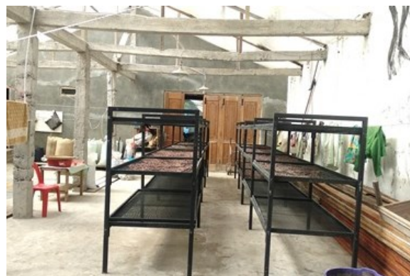
Gambar 5. Implementasi Rak Pengereng Sistem Knockdown di Lokasi Mitra
