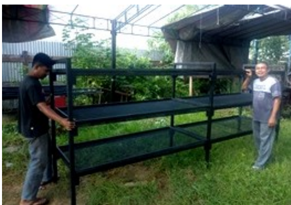
Gambar 4. Rak Pengereng Kopi Sistem Knockdown Hasil Fabrikasi
