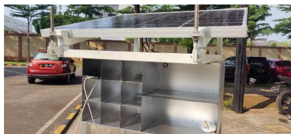
Gambar 2: Purwarupa Stasiun Pengisian Daya Berbasis Tenaga Surya
