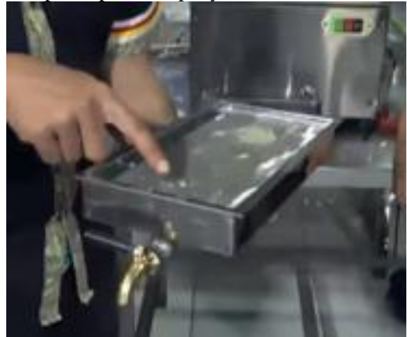
Gambar 2. Penampungan sementara sari tebu yang dilengkapi saringan halus dan kran penyaluran sari tebu.
